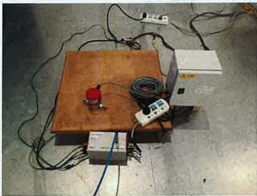
照片 5 射频场感应的传导骚扰抗扰度试验
